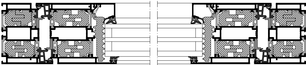
① Aufsatzfüllung verklebt einseitig Mounted infill, bonded, on one side
